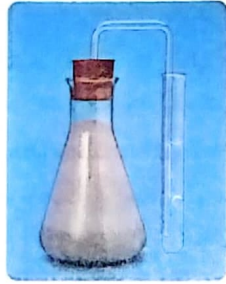
عاش (CO2) الناتج عن عملية التخمير الكحولي يمتص ماء الجير الزرنيق
